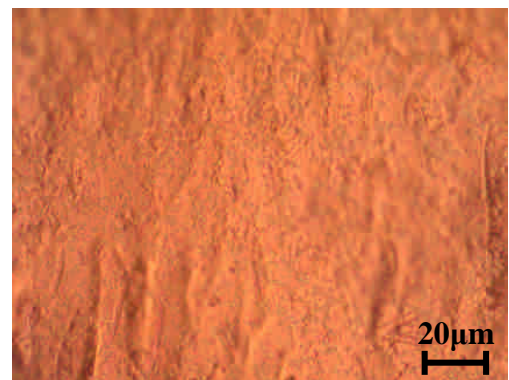
圖 4 氧化鋁陶瓷表面銅電鍍層形貌
